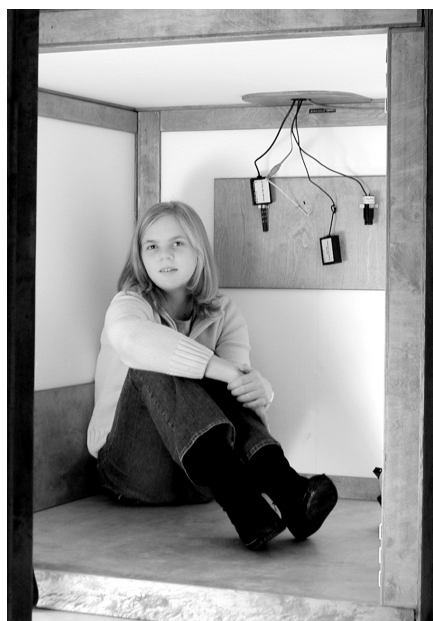
Figur 1. Kammare för mätning av kroppens effekt. Kammaren är byggd av värmeisolerande cellplastskivor och plywood. I kammaren finns mätinstrument för temperatur, luftfuktighet, koldioxidhalt och syrehalt.
