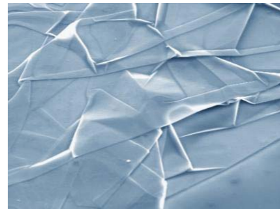
Ett lager av kraftigt skrynklad grafen, avbildat med ett svepelektronmikroskop. Bild: FOM, Nederländerna
