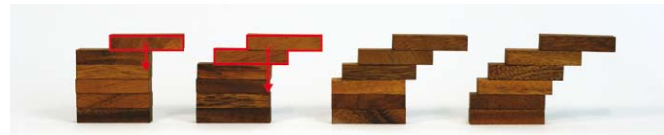
Figur 3. Flytta klossarna successivt medan du tar hänsyn till tyngdpunktens placering. Förskjut först den översta, sedan de två översta klossarna. De röda kryssen visar tyngdpunkten för den översta respektive de två översta klossarna tillsammans.
