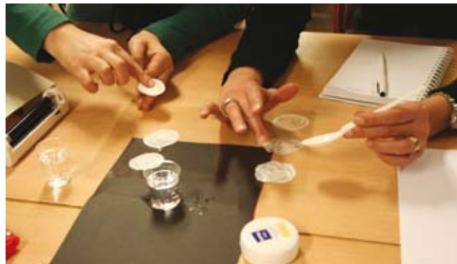
Preparering av plastfilm för att undersöka hur tjockt lager solkräm som behövs för att stoppa UV-strålning. Det visar sig att det behövs ett lager som är tjockare än vad de flesta tror.
