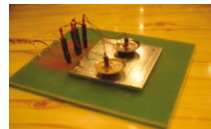
Utrustningen som användes för att, med differentialtermometrisk metod, bestämma stelningstemperaturen för en kristallin substans i tävlingsens experimentella uppgift.
