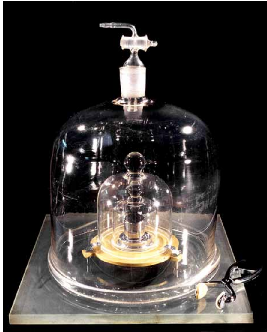
Den nuvarande kilogramdefinitionen är en metallcylinder som förvaras på Internationella mått- och viktbyrån utanför Paris. Det här är en kopia – det riktiga kilogrammet är för värdefullt för att plockas ut för fotografering.
