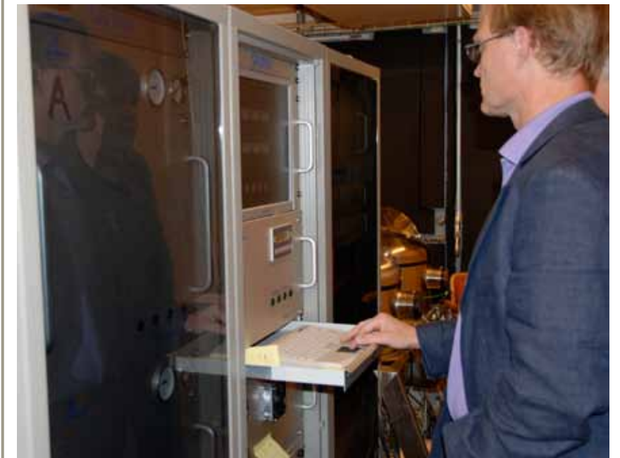
FOI-forskaren Klas Elmgren förevisar Sauna II för Fysikaktuellt utskick. I skåpen finns bland annat molekylsiktare, kolonner med aktivt kol, ugnar för upphettning och datorer. Detekteringen av beta- och gammastrålning sker i de två metallcylindrarna som syns bakom skåpen.
