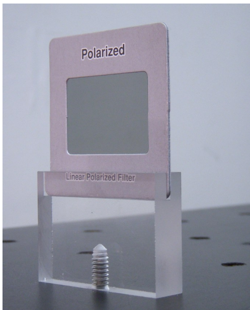
Polarisator monterad i diabildsram med akrylstöd (MÄRKNING K).
