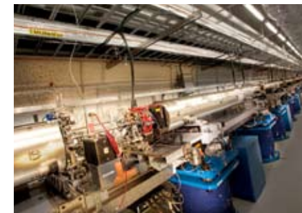
Den 120 meter långa undulatorn vid LCLS.
