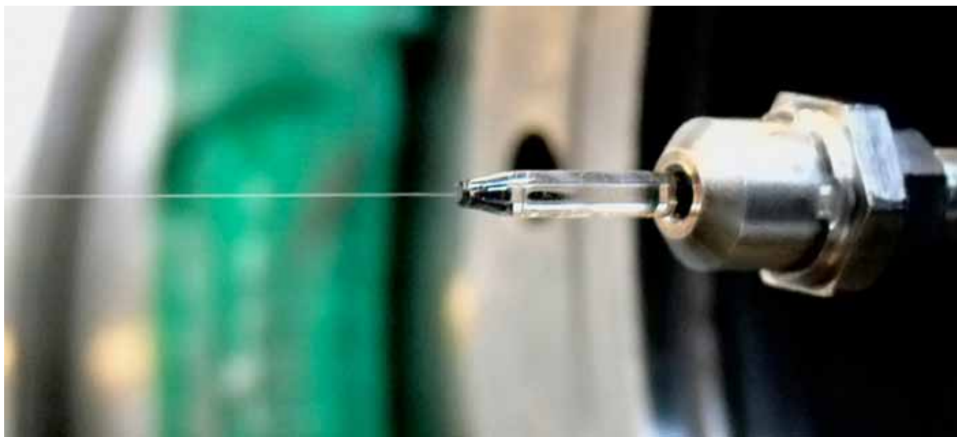
En vätskejet med 15 mikrometers diameter som injiceras i en vakuumkammare möjliggör det som borde vara nära omöjligt; att mäta vattens och vattenlösningars fotoelektronspektra.
