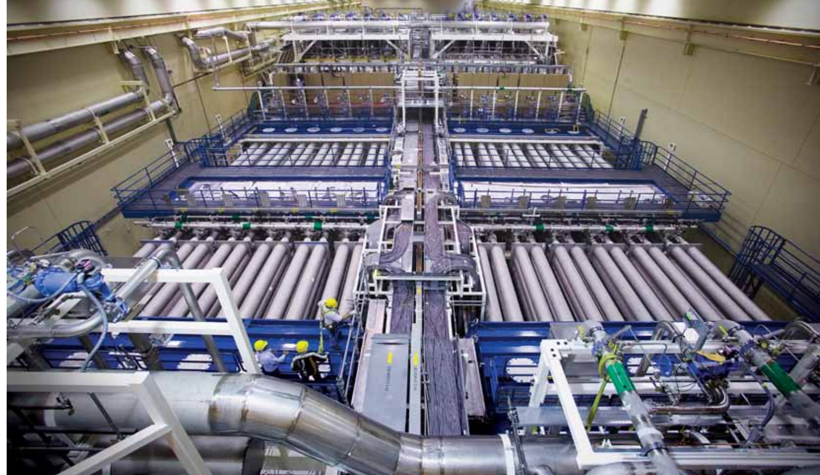
National Ignition Facility (NIF) i USA är världens kraftfullaste lasersystem. På bilden syns 24 \times 4 = 96 rör i vilka varje laserpuls vid 1053 nm våglängd förstärks så att den innehåller 20 kJ energi. I ett identiskt rum bredvid finns övriga 96 strålgångar. Strax innan pulserna når deuterium-tritiumpelleten våglängdskonverteras ljuset till 351 nm. Teknikerna i gula hjälmarna ger en uppfattning om NIF:s storlek.
