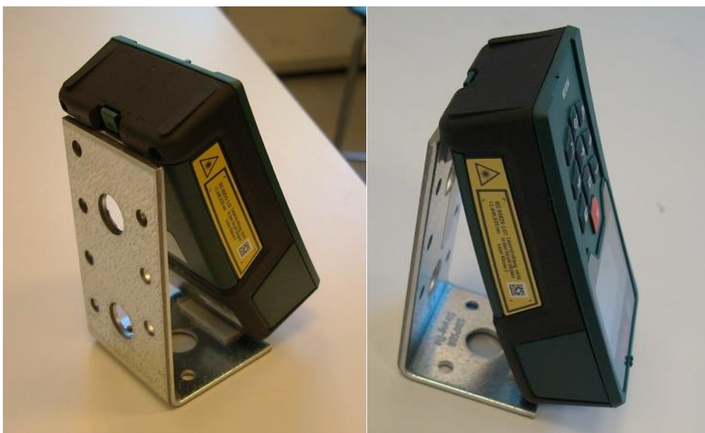
Figur 1.8 Placering av laseravståndsmätaren på vinkeljärnet.
