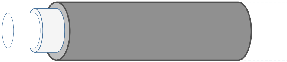
Figur 1.4 Schematisk bild av en fiberoptisk kabel.
