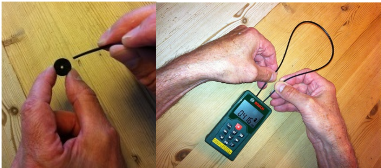
Figur 1.5 (a) Filtkudde och fiberoptisk kabel. (b) Anslutning av den fiberoptiska kabeln.
