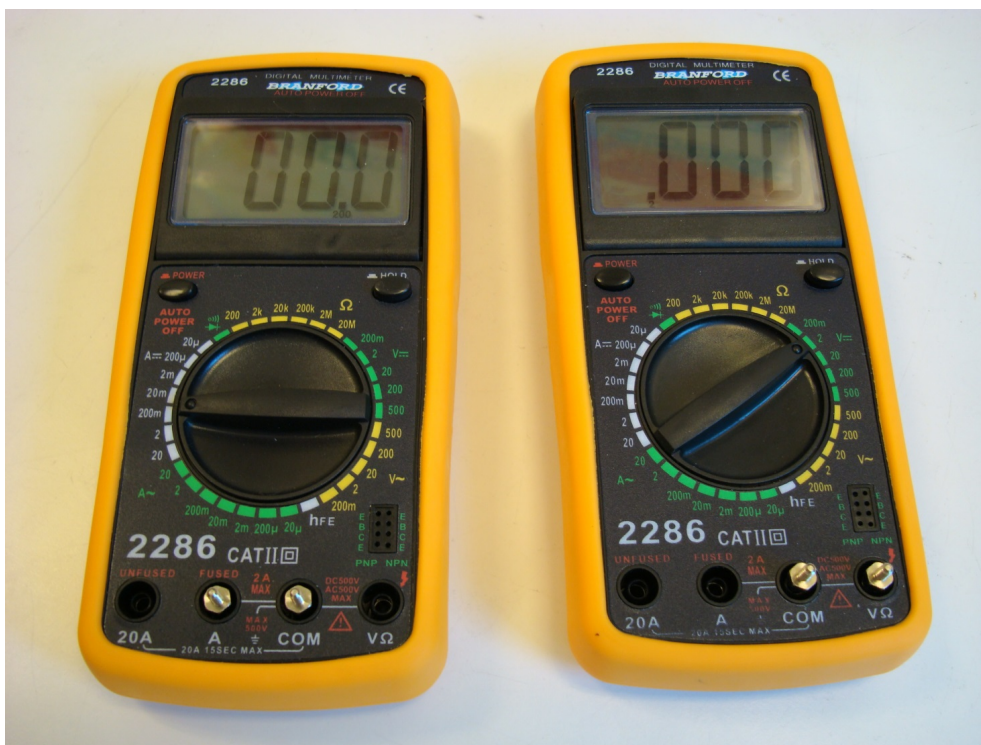
Figur 2.3 Multimetrar utrustade med anslutningar för användning som ampèremeter ( vänster ) respektive voltmeter ( höger ). Instrumentet slås på genom att trycka på “POWER” i övre vänstra hörnet. Instrumentet slås automatiskt av när det inte använts på en stund. Det kan mäta såväl likström och likspänning (=) som växelström och växelspänning (~). Den inre resistansen i voltmetern är 10 M \Omega oavsett mätområde. Potentialskillnaden över ampèremetern är 200 mV vid fullt utslag, oavsett mätområde. Vid överträde av mätområdet visas “1”, som indikation för byte till ett högre mätområde. “HOLD”-knappen (övre högra hörnet) skall inte tryckas in om man inte vill frysa ett mätvärde.
