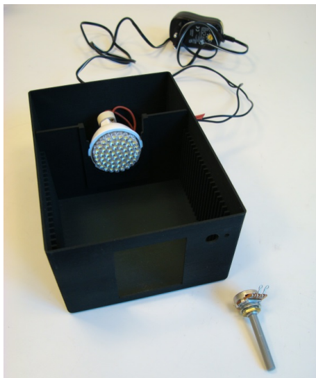
Figur 2.2 (a) Låda med ljuskälla och resistor för montering. (b) Resistorn monterad i lådan. Notera den lilla klacken i resistorns fäste, som passar in i motsvarande urborrade hål till höger om infästningshålet i lådan.
