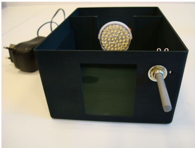
Figur 2.2 (a) Låda med ljuskälla och resistor för montering. (b) Resistorn monterad i lådan. Notera den lilla klacken i resistorns fäste, som passar in i motsvarande urborrade hål till höger om infästningshålet i lådan.
