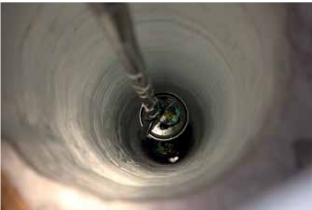
En IceCube-modul på väg ned i det vattenfyllda hålet (2010).
