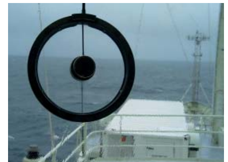
Figur 2: Klarsiktsruta, en snabbt roterande ruta tar bort både imma, regn och saltvattenstänk.
