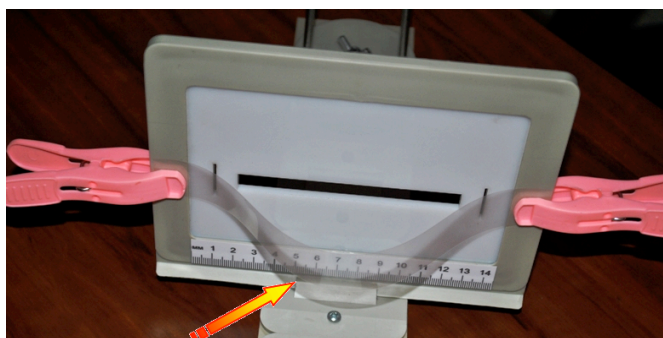
Fig. 1B Uppställning för observation av dubbelbrytning i plastlinjal.
