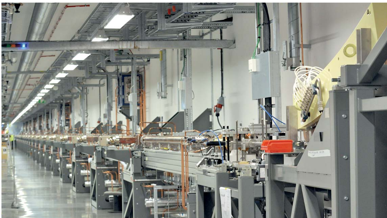
Elektronkanonen (tv) och början av linjäracceleratoren i MAX IV. Foto: Annika Nyberg
