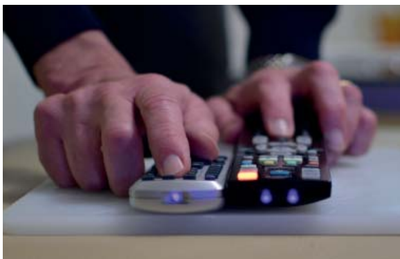
Figur 2: IR-ljuset från fjärrkontroller verkar lysa violett sett med en digitalkamera
