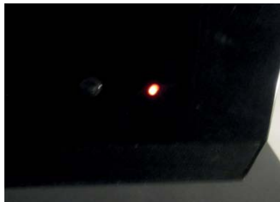
Figur 1: IR-sensorn på TV:n syns till vänster om kontrollampan. Framför sensorn sitter en konvex lins för att ge ett bredare siktfält.
