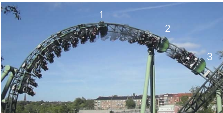
Fig. 1: Tågets fart i högsta läget är ca 12 m/s. Ändringen i masscentrums höjd gör att farten är högre när övriga delar av tåget passerar högsta punkten. Med hjälp av tåglängden 12,5 m och en uppskattning av tågbågens vinkel för de olika lägena, ca 81^\circ , 48^\circ resp 26^\circ , erhålls krökningsradierna 9 m, 15 m, 28 m. Masscentrum kommer då att ligga ca 2,7 m, 0,4 m resp 1,0 m under tågets högsta punkt för lägena 1, 2, 3 i figuren. Enligt denna uppskattning kommer den som åker i första vagnen att tryckas nedåt av sätet med ca 0,3mg när högsta punkten passerar, medan den som sitter i mitten i stället trycks uppåt av bygeln med ca 0,2g i högsta punkten och en person längst bak är nära tyngdlöslöbet.
