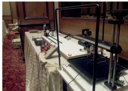
Figur 3: Den nära 3 m långa experimentuppställningen där den vita delen användes för diffraktionsmätningarna. Närmast syns det svarta vattentråget för vågalstring.
