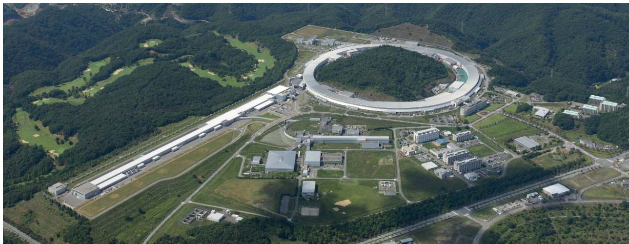
Bild 5, ovan: Röntgenfielektronlasern SACLA vid Spring-8 i Japan. Den 700 m långa byggnaden som innehåller acceleratoren och undulatorerna sträcker sig från elektronkanonen i byggnaden längst ner till vänster till experimenthallen närmast den stora lagringsringen som är byggd kring Mt. Miharakuriyama. © Riken Spring-8 Center
