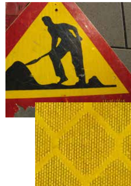
Figur 5: Förstorad bild av reflekterande plastfolie på vägschild med mikroskopisk hörnreflektorsstruktur. Varje stor ruta är 4-5 mm längs diagonalen.
