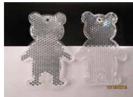
Figur 2: Isärtagen reflexbricka, där den vänstra delen är rättvänd och reflekterar tillbaka ljuset. Den högra delen är felvänd och den ser man igenom och därför syns både det vita och svarta underlaget. Obs! De strålar som korsar högra delen och när kameran, måste ha infallit snett mot brickan, då allt ljus som infaller rakt reflekteras.
