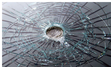
FIGUR 2 Vindruta med skottskada med det spindelnätsliknande mönster som är typiskt för laminerat glas.
