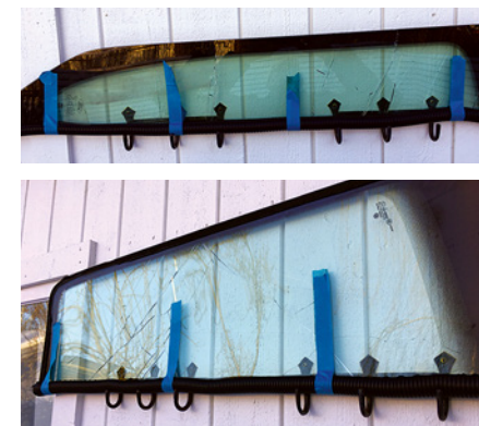
FIGUR 5 Överst bakruta och underst vindruta, som Ryds Bilglas förutseende försett med skärskydd, fäst med blå tejp, längs brottkanterna.
