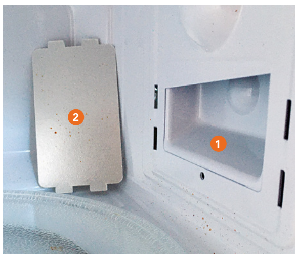
FIGUR 3 Till höger i kammaren sitter vågledarens utlopp (1). Det är här frilagt och glimmerskivan (2) är ställd vid sidan.
