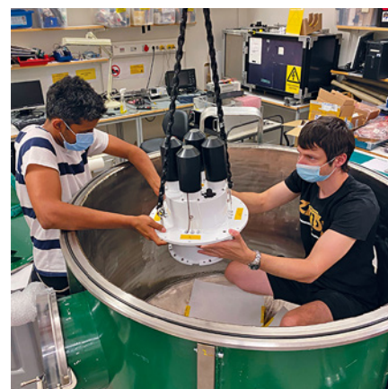
FIGUR 4 Antikoincidenssystemet lyfts in i vakuumtanken av KTH-forskarna Nirmal Iyer och Mózi Kiss. Tester kommer att simulera förhållandena på 40 km höjd. KTH-gruppens bidrag till XL-Calibur finansieras av Rymdstyrelsen och Vetenskapsrådet. Kristall-scintillatorn finansieras av KAW Stiftelsen och köptes ursprungligen in för PoGO+-projektet.
