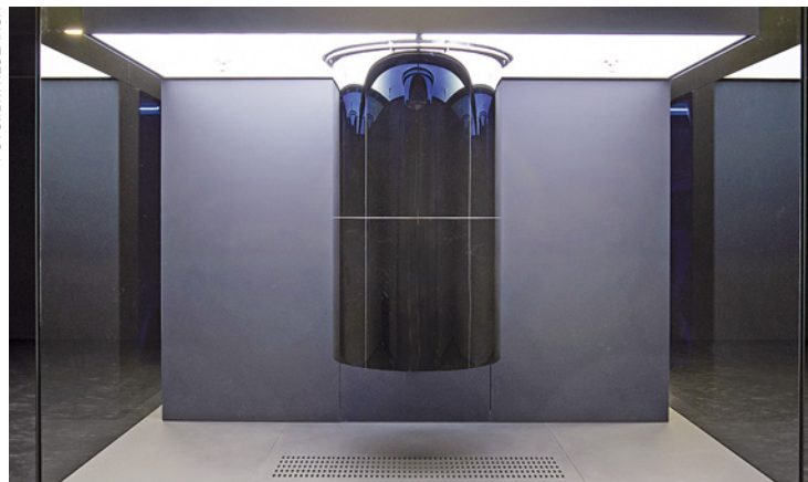
IBM:s kvantdator Q System One, med 20 kvantbitar.
