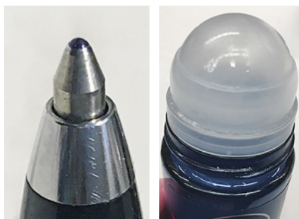
FIGUR 1 Till vänster kula av nötningsstål- kiselkarbid eller volframkarbid (cirka 9 på Mohs hårdhetsskala). Till höger kula av plast till en deodorant.
