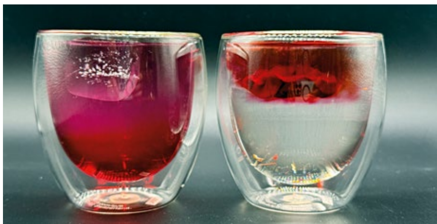
Lite karamellfärg, droppad bredvid isbitarna, avslöjar hur det kalla smältvattnet rinner mot botten i det osaltade vattnet (vänster), men stannar nära isbiten i det saltade (höger).
