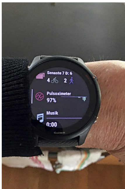
FIGUR 3 Överst till vänster pulsoximeter för finger. Överst till höger absorptionen av syresatt och syrefattigt blod. Underst pulsklocka med pulsoximeter-värde.
