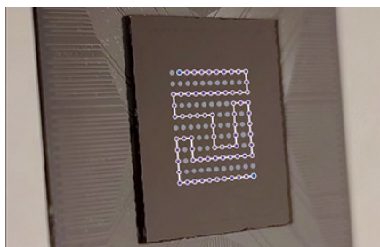
FIGUR 3 Kinesiskt kvantdatorchip med 100 kvantbitar. De sitter på en yta, men är kopplade "i en linje", som figurerna i den här artikeln.
