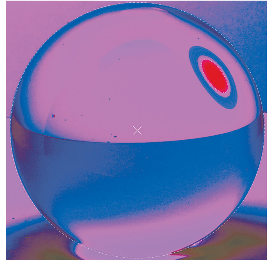
En av teoriuppgifterna utgick från detta foto av en glaskula. På kulans baksida har en smal tråd limmats fast. När kulan fotograferas i dikromatiskt rött och violett ljus avbildas en liten bit av tråden som ellips. Varför?
