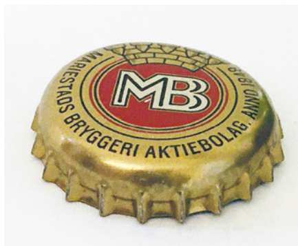
FIGUR 1 Kronkork, 26 mm av 0,2 mm tennfri stålplåt med plastinlägg och givetvis 21 tänder. Den väger cirka 1,9 g och passar till flaskor med 26 mm hals.
