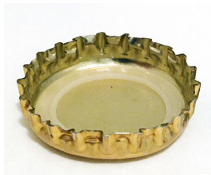
FIGUR 1 Kronkork, 26 mm av 0,2 mm tennfri stålplåt med plastinlägg och givetvis 21 tänder. Den väger cirka 1,9 g och passar till flaskor med 26 mm hals.
