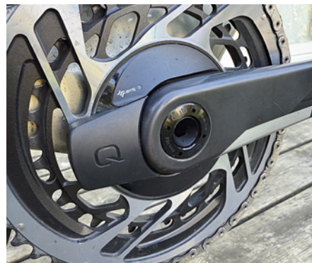
FIGUR 1 Till vänster vevarm med kraftgivare och batteri (knappcell). Till höger vevhusmontage.
