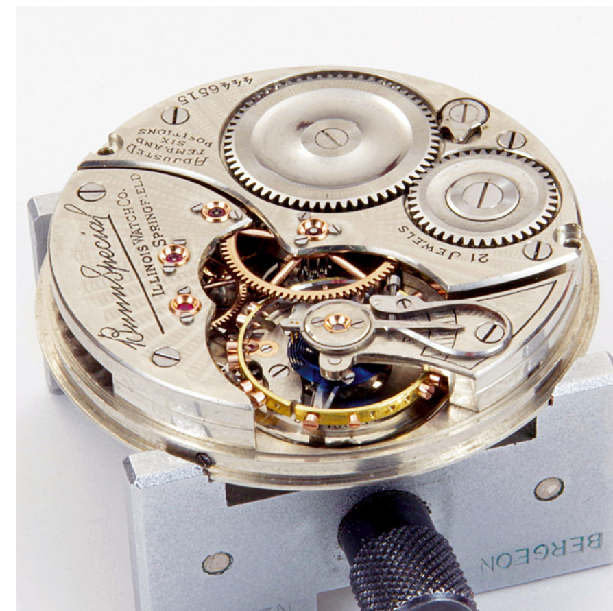
Invar används fortfarande i diverse precisionsinstrument, som till exempel balansfjäders i den här tågkronometern.
