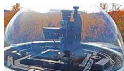
FIGUR 2 Kupolen med instrument ovanpå stationernas små "hus". Från vänster: ALIS_4D kameran med filterhjul (6 filter), meteor-kamera. Ramarna längst ned är positioneringssystemet som gör det möjligt att rikta kameran mot en viss del av himlen.
