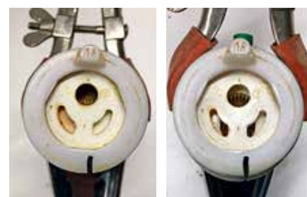
FIGUR 2 På översta bilden kommer vattnet upp genom de två njurformade öppningarna. Nere till vänster och till höger syns kartuschen uppochnervänd. Den reglerar flöde om spaken lyfts och temperatur om spaken vrids. Till vänster avstängd och till höger lagom flöde, där lika mycket varmt som kallt vatten släpps fram. Vattnet blir ljummet.
