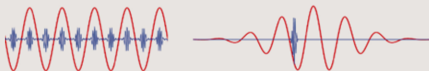
FIGUR 4 Båda experimenten 2001 använde fältet för en infraröd laser till att mäta pulslängden på attosekundpulserna. I Agostinis fall var det ett pulståg av attosekundpulser där tiden mellan två pulser motsvarar en halv IR-cykel (vänster), medan Krausz skapade en isolerad attosekundpuls med hjälp av en IR-puls som bara var några cykler lång (höger). I båda fallen studerades sedan fotoelektronernas energi som funktion av tidsfördröjningen mellan fälten.
