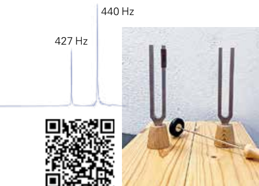
FIGUR 2 Två stämgaflar med aningen olika frekvens. Svävningen hörs tydligt i ljudfilen: www.fysikersamfundet.se/wp-content/uploads/Svavning.mp3 .
