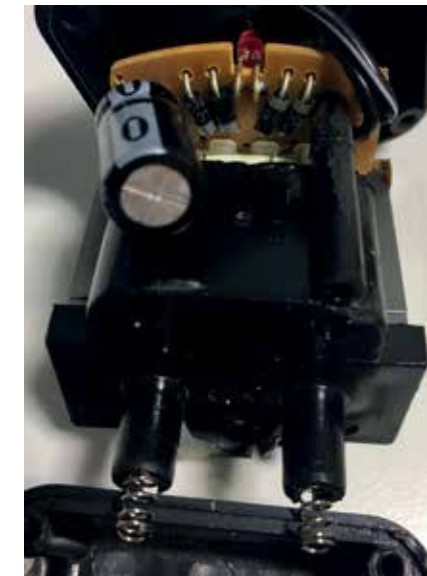
Bild 2: Fulltransformator med bladad kärna av mjuk transformatorplåt. Primärsidan har tunn tråd medan sekundärsidan har tjockare. För att från 230 V erhålla 5 V krävs 46 gånger så få varv i sekundärindringen. Likriktarbryggans fyra dioder och en glättningskondensator på sekundärsidan syns upptill i bilden, vilket ger helvågslikriktad DC.
