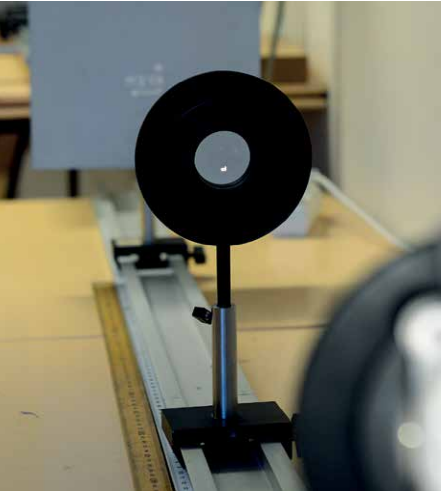
Figur 1: Optisk bänk med bildföremål, lins och bildskärm.
