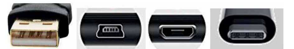
Bild 4: Från vänster: USB-A, mini-USB, mikro-USB och USB-C.
