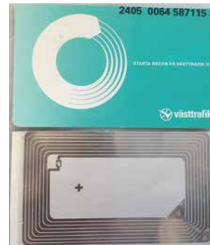
Figur 2: Itudelat smartcard för 13,56 MHz från Västtrafik. Chippet syns uppe till vänster innanför antennslingorna. Uptill syns läsarens magnetiska fält, vilket inducerar spänning i en passiv tagg.
