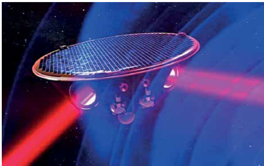
Bild 2: En skiss av en av LISA-sonderna i rymden. Solcellerna för elförsörjningen syns på ovensidan, de två teleskoperna med lasrarna därunder och i mitten ses några av de små raketmotorer som håller sonden låst i läge och orientering av de fritt fallande testmassorna innanför.
