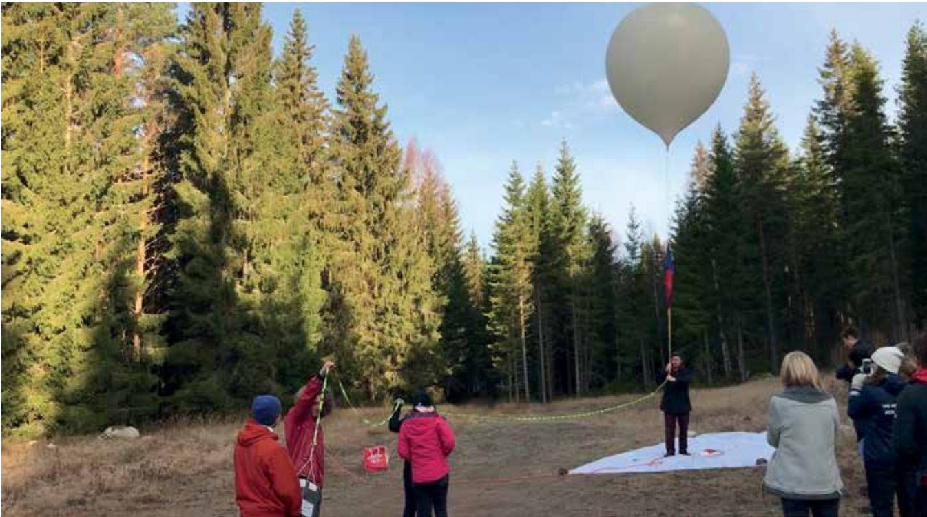
Figur 3. Ballongsläpp från Dalarna. En detektor för kosmisk strålning hänger under ballongen (den vita lådan i slutet av det gula repet). Källa: Vetenskapens Hus.
