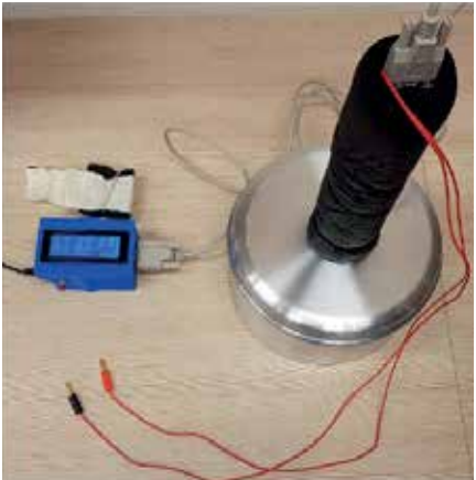
Figur 3: Rör och temperaturgivare inuti svart isolering ovanpå en kastrull, samt Allt-i-allo-låda för datalagring och tidtagning.
