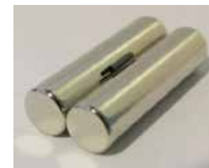
Figur 2: Magneter med 25,4 mm längd och 3,2 mm radie.
