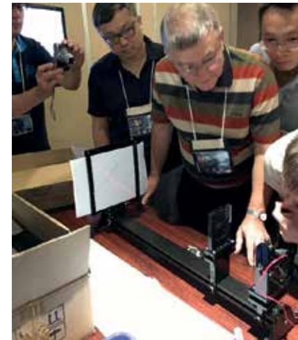
Figur 1: Lasern till höger belyser kyvetten och på skärmen syns en dipp, tyvärr svagt.
