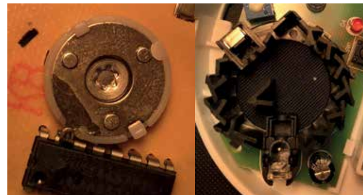
Figur 2: Till vänster syns i mitten det fastsatta foliet med Am-241 och till höger klockan sex syns IR-dioden och klockan 10 syns fotodioden. Notera det V-formade hindret.
