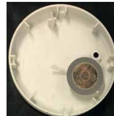
Figur 3: En tunn metallskiva med 3,5 cm diameter och likaledes tunn piezoelektrisk (brun) keram. Skivan ligger an mot de tre fjädrande kontakter som i figur 1 syns ovanför respektive mätkammare.
