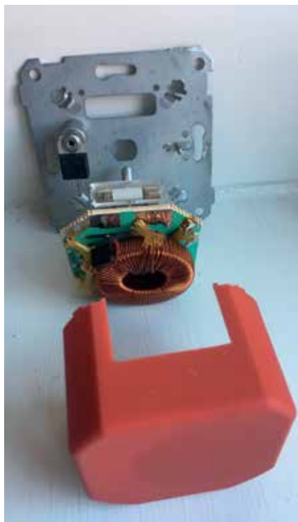
Figur 1: Väggdimmer från mitt vardagsrum. Vrid ratten (1) förbi ändläget så den slirar och dra loss, lossa centrummuttern (2), lyft av centrumplattan och ramen (3). Nederst är dimmern isärtagen, sedd bakifrån.
