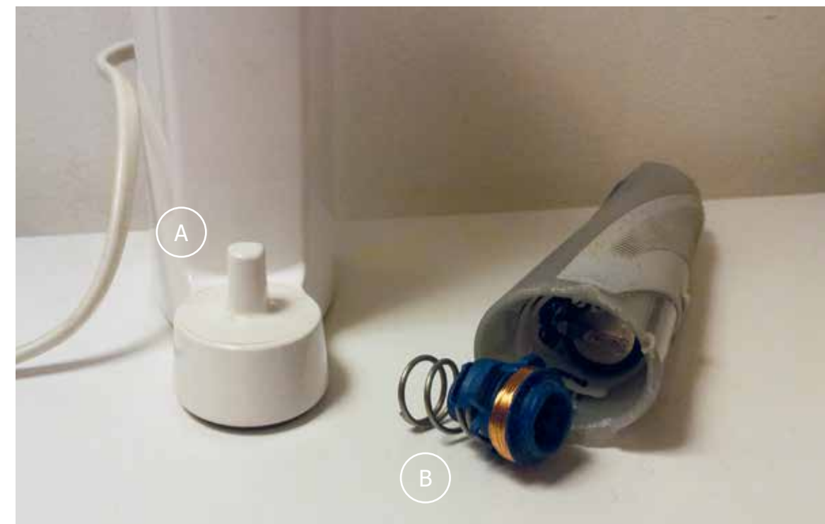
Figur 2: El tandborste där ena spolen finns inne i pinnen vid A och den andra finns i botten på tandborsten vid B. Innanför spolen skymtar botten på batteriet.
