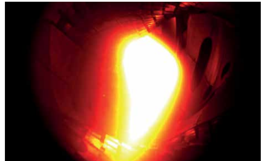
Det första plasmat i Wendelstein 7-X den 10 december 2015. Plasmat som bestod av helium nådde en temperatur av en miljon grader Celsius och varade i en hundradels sekund. Bara några dagar senare hade man uppnått över 40 miljoner grader. Copyright IPP.
