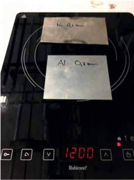
Figur 3, vänster: Al-plåt och Ni-plåt på hällen. Ni uppvärmdes mycket mer än Al. Plåtarna låg först intill varandra, men Ni-plåten repellerades och flyttade sig uppåt på fotot.
