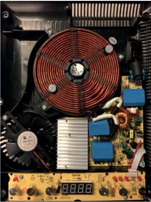
Figur 2: Under hällen finns spolen, en fläkt, kylfläns samt elektronik. De två vita kablarna leder strömmen till spolen.
