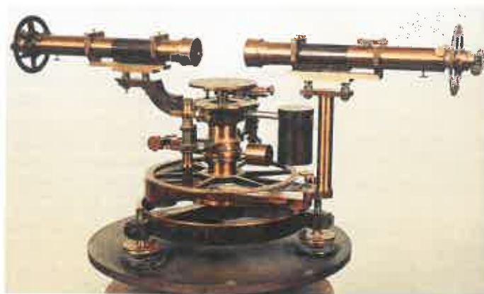
Figur 4. Ångströms spektrometer från Pistor och Martins i Berlin, ett utmärkt exempel på högt driven precision i tillverkning av instrument. Fysikum, foto Teddy Thömlund.
