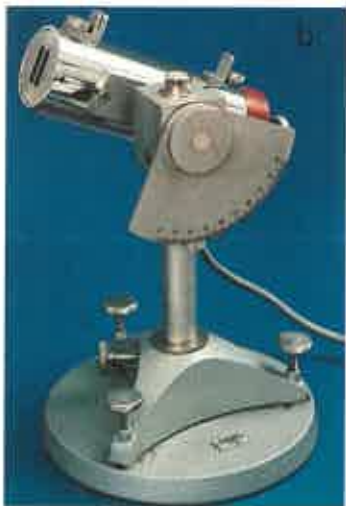
Figur 8. (a) Kompensations-pyrheliometer av Knut Ångströms konstruktion. Instrumentet antogs 1905 som internationell standard för mätning av solstrålningens intensitet. (b) Modern pyrhemeter, SMHI, Norrköping. Fysikum. Foto Teddy Thörlund.
