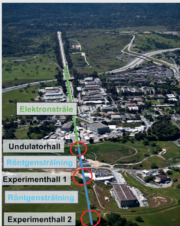
Figur 10: Vy över SLAC National Accelerator Laboratory med den första röntgenlaseranläggningen i världen, Linac Coherent Light Source (LCLS). Den gröna delen är den sista kilometern av den linjära acceleratoren, vilken används för att accelerera elektronpulser till 14 GeV. Pulserna passerar en undulator där de ger upphov till röntgenstrålning, som sedan transporteras vidare till olika experimenthallar.
