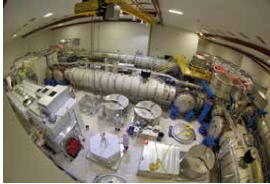
Figur 7: En vakuumanläggning i LIGO Hanford som innehåller laser, stråldelare, testmassor och annan utrustning (foton från Caltech/MIT/LIGO Laboratory).
