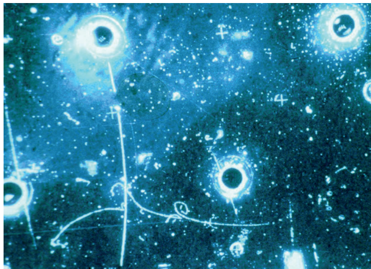
Figur 2: Den enda händelse i Gargamelle som innebar upptäckten av processen \bar{\nu}_\mu + e^- \rightarrow \bar{\nu}_\mu + e^- . Elektronen startar i nedre högra delen av bilden och rör sig åt vänster medan den förlorar energi till bromsstrålningsfotoner som i sin tur konverterar till e^+e^- -par (foto CERN).
