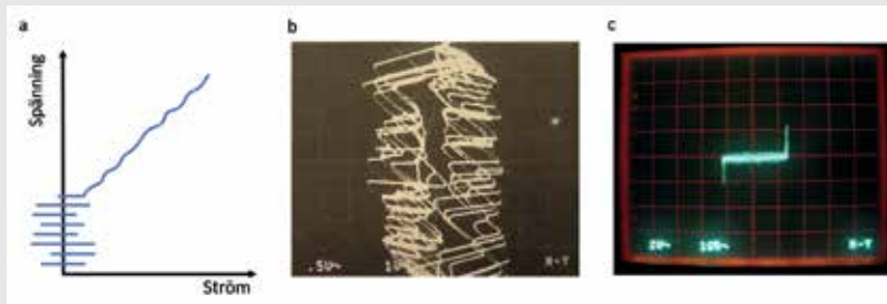
Figur 5: (a) Skissen visar ett typiskt utseende för spänningsstegen som brukar kallas "zero crossing steps" i en array med hög shuntresistans och kapacitans. I (b) syns en oscilloskopbild som visar hur det ser ut då yttre störningar gör att spänningen över arrayen hoppar mellan de olika spänningsstegen. Arrayer som bygger på metoden att utnyttja "zero crossing steps" är till sin natur instabila och är därför mer utmanande att använda. Fördelen är å andra sidan en mycket tillförlitlig kvantisering av stegen. (c) En oscilloskopbild av en programmerbar array som uppvisar ett stabilt spänningssteg. (Bilder: Gunnar Eklund/Karin Cedergren)
