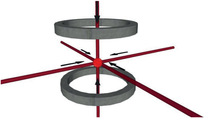
Figur 2. Schematisk illustration av en magneto-optisk fälla. Sex motriktade laserstrålar används för att kyla och fånga atomer. Laserstrålarna är noga justerade, både i intensitet och frekvens. Genom att laserljuset har en frekvens som är något under atomernas resonansfrekvens kommer atomerna att bromsas (kylas) när de rör sig emot laserstrålarna på grund av Dopplereffekten. För att också skapa en positionsberoende fälla används även elektriska spolar för att skapa ett inhomogent magnetfält.
