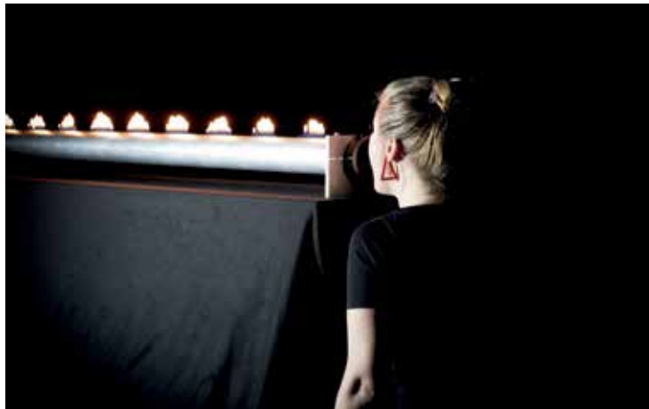
Figur 3: På bilden ser ni hur det skapas en stående våg i röret när Hedvig Jalhed tar en ren ton. Vid tryckbukarna kommer flammorna att vara högre och vid noderna trycks det inte ut någon gas alls. För en stående våg är avståndet mellan två bukar en halv våglängd. För att skapa en stående våg i röret måste randvillkoren vara uppfyllda, så det är bara vissa frekvenser som skapar fenomenet. Om man sjunger i röret kommer flammorna därför att hoppa runt. I filmen som ni kommer till via QR-koden (se efter ”Vidare läsning”) sjunger Hedvig en bit ur arian Lascia ch’io pianga av Händel (foto: Magnus Pålsson).
