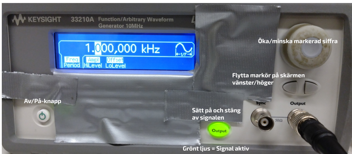
Figur 4: Panelen på signalgeneratorn och förklaring till relevanta knappar. Notera att displayen använder decimalpunkt istället för decimalkomma, dvs frekvensen är inställd på 1 kHz på bilden.
