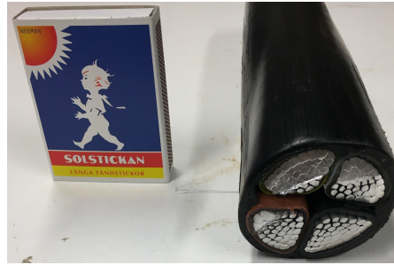
Figur 1: Tvärsnitt av en typisk mark-kabel (samt en tändsticksask för skala).
