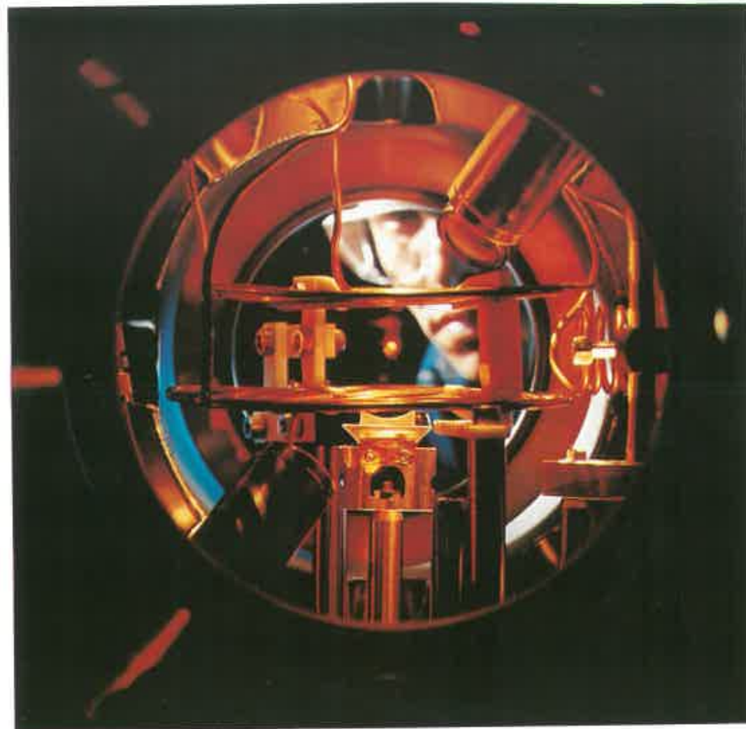
Figur 6. Den gula punkten i fotografiet är natriumatomer fångade i en MOT. Magnetfältsgradienten bildas av de två spolarna, och sex stycken laserstrålar sammanstrålar i symmetripunkten. Den krökta ytan under den nedre spolen är en atomär spegel (se avsnittet om atomoptik).
