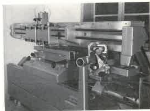
Fig. 9. Fotoelektrisk, interferometrisk komparator vid BIM för precisionsmätning av längdstandarder och direkta jämförelser mellan dessa och den nya optiska meterstandard.
