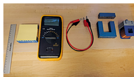
Utrustning för att bestämma vakuumpermeabiliteten. Vad ska alla post-it-lappar användas till? Svaret på frågan, liksom tävlingsuppgifterna i sin helhet, finns under fliken "Wallenbergs fysikpris" på Fysiker-samfundets hemsida.
