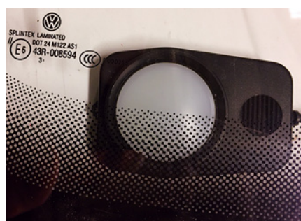
FIGUR 1 Halvtonsmönster, 3,5 cm brett, i kanten av en vindruta. När jag lade givaren till luxmeters halv vägs in sjönk transmissionen från cirka 80 till 67 procent och när hela mönstret precis täcktes, sjönk transmissionen till 29 procent.
