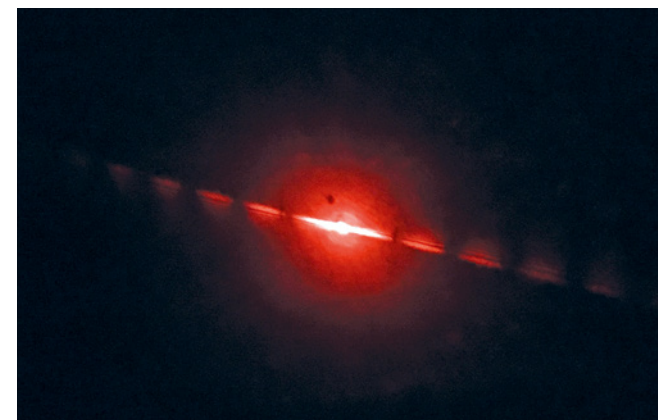
FIGUR 4 Diffraktionsmönster med HeNe-laser (våglängd 633 nm) från en värmetråd. Centralmaximets bredd är 4 cm på 90 cm skärmavstånd, vilket ger en tråddiameter på 30\text{ }\mu\text{m} .
