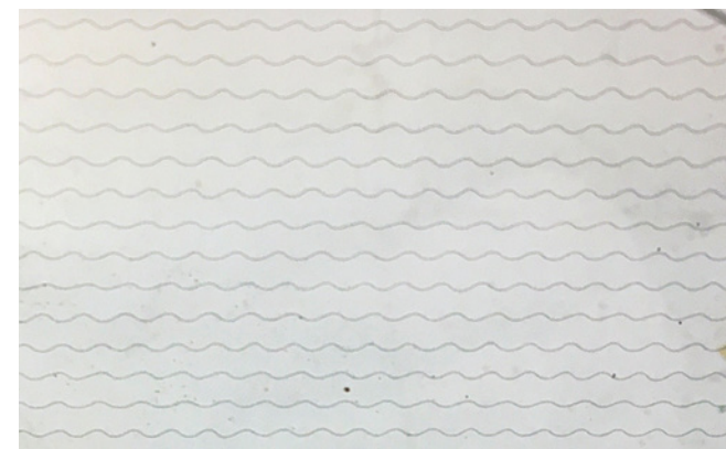
FIGUR 3 Värmetrådar med 2,5 cm inbördes avstånd i en laminerad vindruta.
