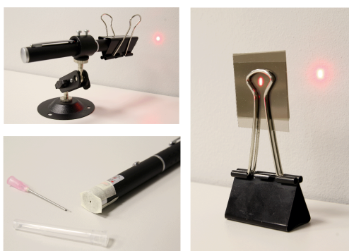
Figur 19: Lasern kan hållas tänd med stora klämman. Vill du minska strålytan tejpa för en bit maskeringstejp och gör ett mindre hål med en nål. Ljusintensiteten minskas med mörka filmen.
